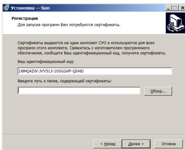
3.2.17. В системе используется один комплект сертификатов для всех модулей системы. При установке модулей на другие компьютеры системы, программа установки попробует найти сервер автоматически, но путь к папке с сертификатами нужно указать вручную. Если сервер не найден автоматически, в качестве сервера введите сетевое имя сервера или его IPv4 адрес. В случае, если компьютеры в сети получают адреса по протоколу DHCP, необходимо указать сетевое имя компьютера, в противном случае, указать IPv4.
