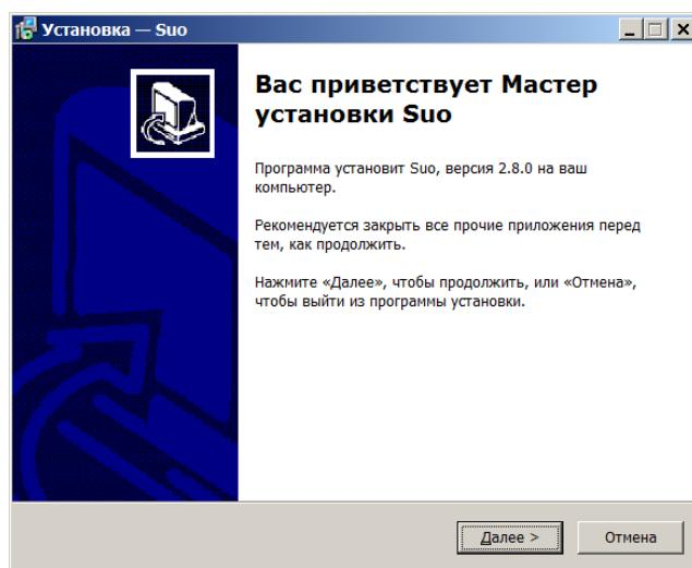
3.2.12. Для корректной работы системы, на каждом компьютере, начиная с сервера необходимо запустить программу установки SuoSetup.exe. Программа установки может быть запущена как с переносного носителя, так и по сети.
