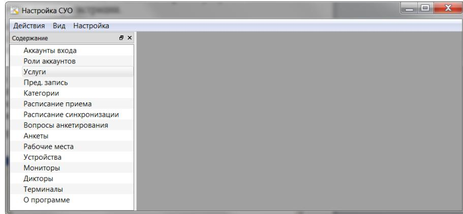
3.3.8. В окне программы – слева находится окно навигации, справа – вкладки с настройками. Вкладки открываются двойным нажатием на пункт в окне навигации. Каждая открытая вкладка обращается к базе данных для обновления параметров. При низком быстродействии сети и большом количестве клиентов, сервер может задерживать обслуживание запросов, поэтому желательно закрывать неиспользуемые вкладки в программе SuoAdmin.
