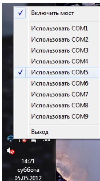
в системном трее. В контекстном меню SuoBridge выбираем «Включить мост» и указываем номер COM порта и его скорость (обычно 9600).
