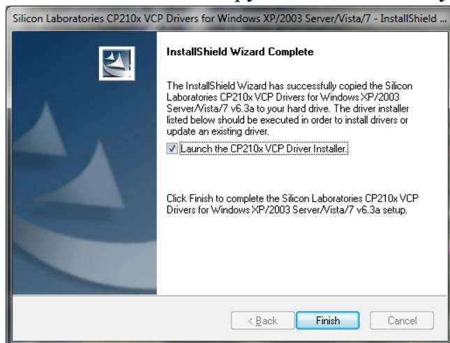
подхватятся автоматически и в системе будет создан новый СОМ порт. Узнаём его номер в диспетчере устройств.
